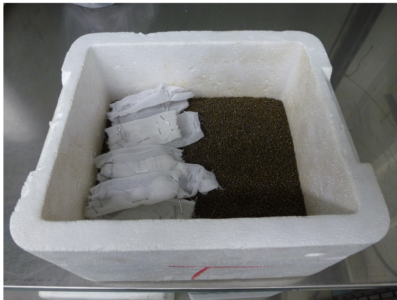
Abb. 9: Styroporbox mit Schrotkugeln und Gazesäckchen zur Untersuchung von Unterkühlungsschäden.
