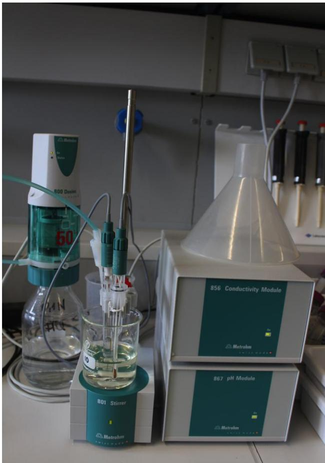
Abb. 11: Der für die Titration der Säurekapazität verwendete Dosimeter
