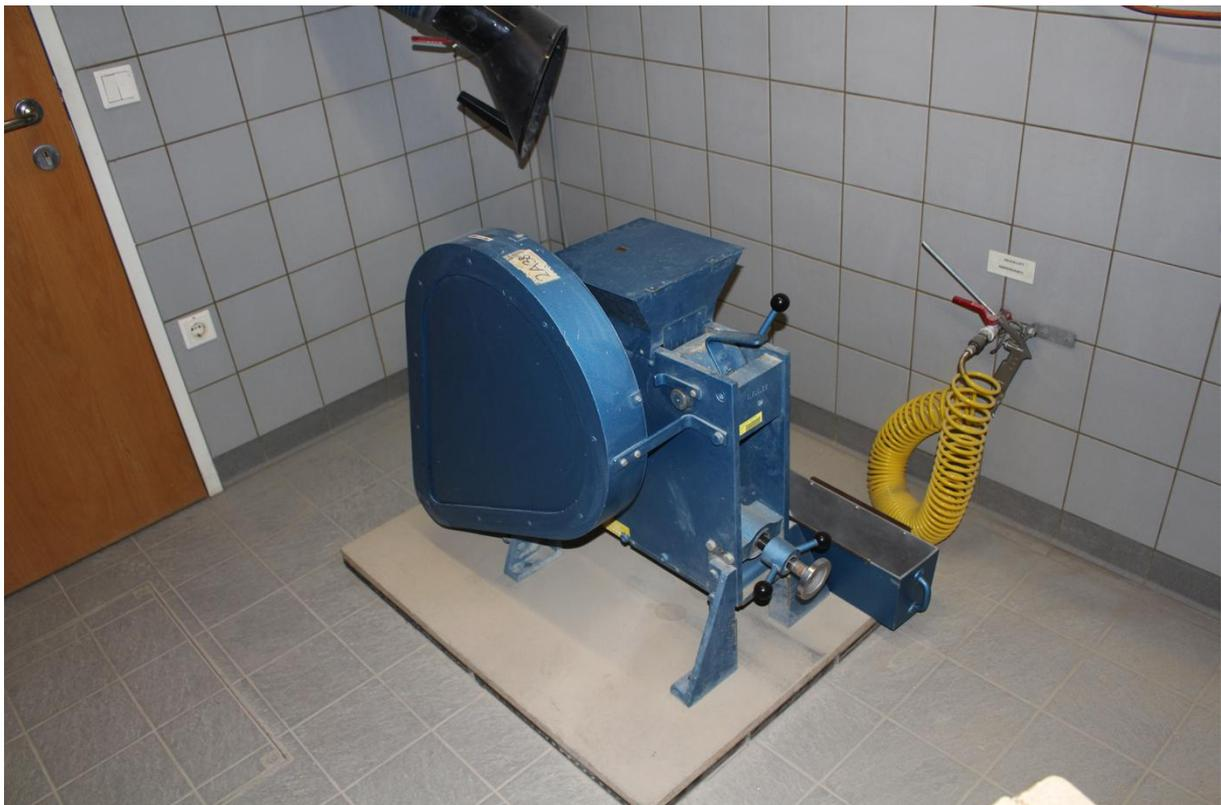
Abb. 12: Backenbrecher zur Zerkleinerung der Gesteinsproben
