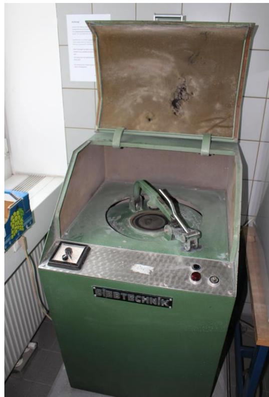
Abb. 13: Die zum Pulverisieren verwendete Achatmühle
