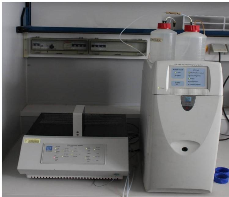
Abb. 15: Der verwendete Ionenchromatograph ICS 100 von Dionex inkl. Autosampler
