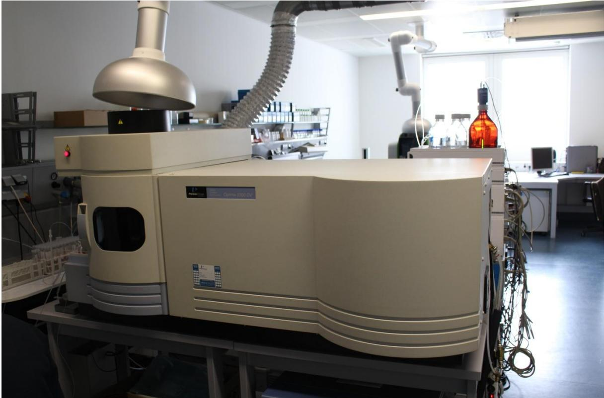
Abb. 16: Verwendete ICP-AES
