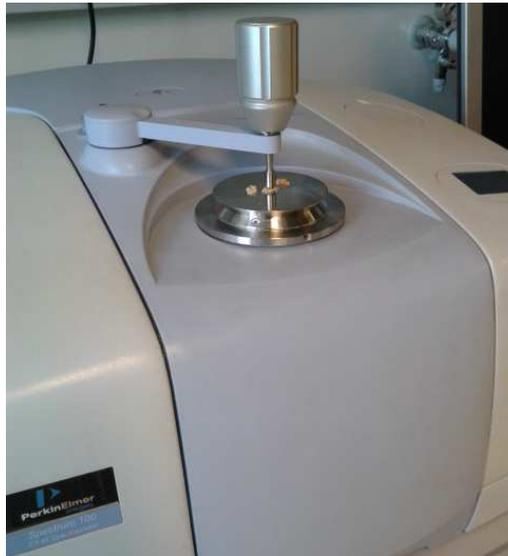
**Abbildung 13.** ATR FT-MIR Spektrometer nach Perkin Elmer
