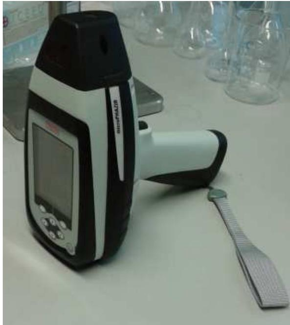
**Abbildung 16.** Handheld FT-NIR-Spektrometer „Phazir“
