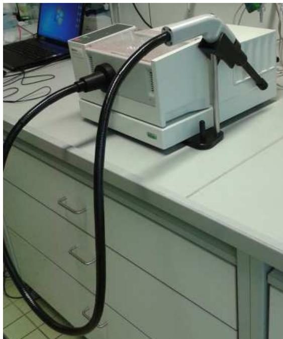
**Abbildung 15.** FT-NIR-Spektrometer nach Büchi mit Solids Messzelle und Fiber Optic add-on
