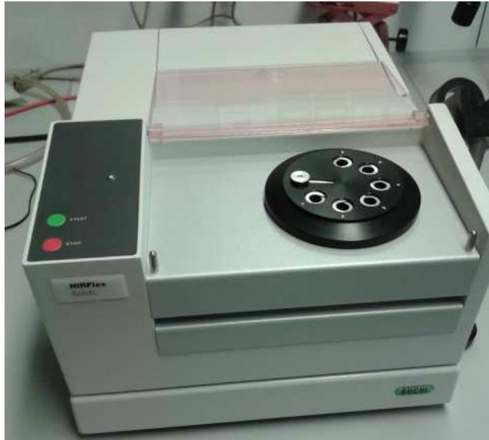
**Abbildung 14.** FT-NIR-Spektrometer nach Büchi mit Solids Messzelle und Vial add-on
