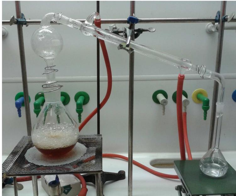
**Abbildung 44.** Destillation der Fluidextrakte zur Ethanolgehaltsbestimmung
