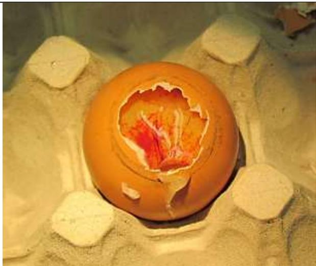
Abbildung 6: Bebrütetes Ei für den HET-CAM-Test
