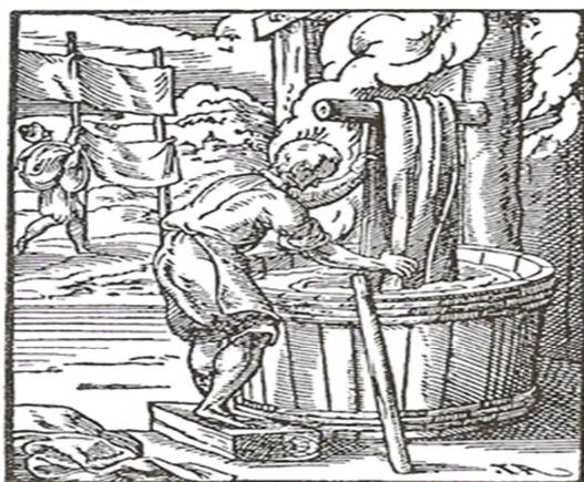
*Färber bei der Arbeit, Holzschnitt von Jost Amman um 1568. Der hier nicht abgedruckte Vers von Hans Sachs spricht vom »Schwarzfärber«, es handelt sich aber um einen Blaufärber, der aus einer Waid- oder Indigoküpe (Holzbottich!) färbt. Der Gehilfe im Hintergrund hängt die Stoffbahnen zum Blauen auf. Ein richtiger Schwarzfärber müsste aus kochender Flotte, aus einem heizbaren gemauerten Kesse färben.*
