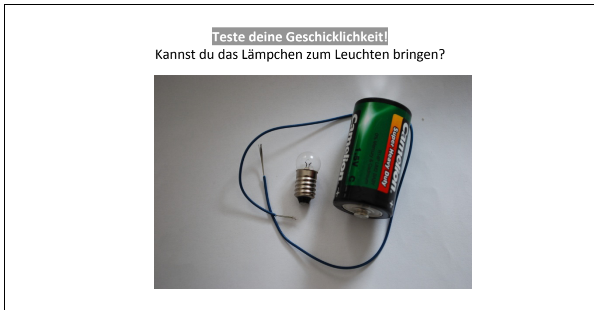
Abbildung 13.2: Eine Aufgabe, die die Vorstellung des geschlossenen Stromkreises schulen soll.
