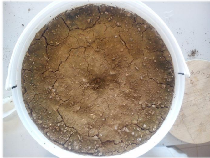
Abbildung 10: Versuchsansatz mit an der Oberfläche sichtbaren Rissen; Standort Kemetten (BAUER 2013)
