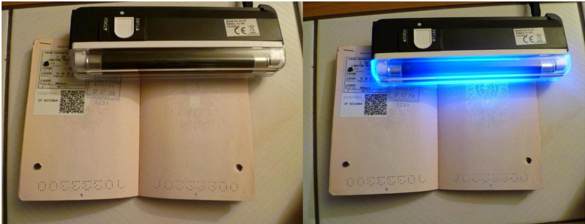
Abb. 2: Vergleich einer Passseite ohne (links) und mit UV-Beleuchtung (rechts). Unter UV-Strahlung wird eine Seitenzahl in der Mitte des Wappens sichtbar.
