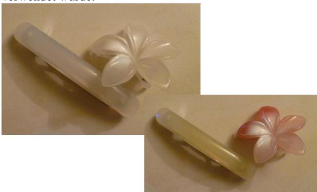
Abb. 4: UV-empfindliche Haarspangen bevor (links oben) und nachdem (rechts unten) sie UV-Strahlung ausgesetzt wurden.
