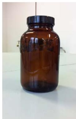
**Abbildung 1:** Braunglasgefäß für die Extraktion durch Mazeration
