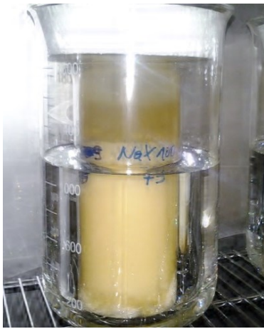
Abb. 7: NaX 100 nach 5 Tagen; erkennbar ist eine Absetzung des Amines
