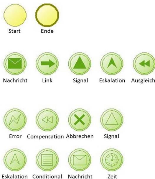
Abbildung 21 zeigt die unterschiedlichen Ereignisformen, die bei der BPMN eingesetzt werden können
