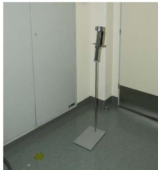
Luftkeimsammler an Stativ in einem Meter Höhe befestigt, links unten Sedimentationsplatte
