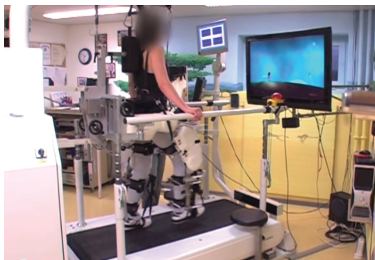
Abbildung 27: Lokomoto zur Steuerung von Gabarello im Einsatz
