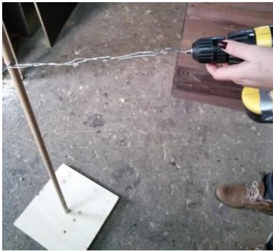
Abbildung 15: Einspannen des Drahtes in die Bohrmaschine (eigenes Foto)
