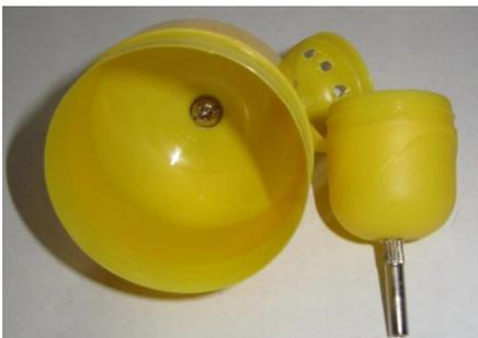
Abbildung 11: Kapseln mit der Hülsenmutter (eigenes Foto)
