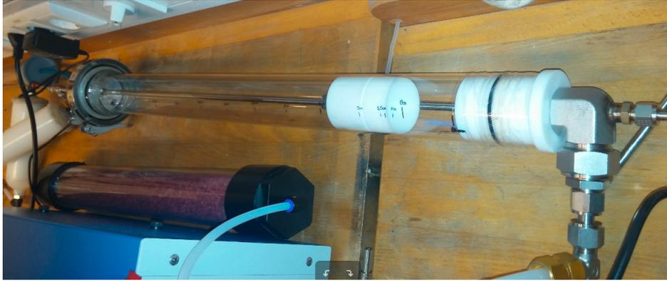
Abbildung 4.8: Die Flow-Tube aus Glas hat eine Länge von 71cm und ein Volumen von 1.4l. Durch diese führt eine Edelstahlröhre mit einem Teflonansatz, welches variable Verweil- und Reaktionszeiten ermöglicht. Das spezielle Core-Sampling am Ende der Flow-Tube ermöglicht einen laminaren Abfluss der Aerosole.
