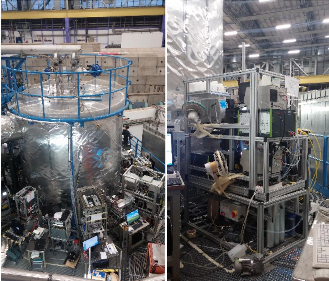
Abbildung 3.2: Links: Die 4m hohe CLOUD-Nebelkammer mit den externen Instrumentierungen. Der DMA-Train befindet sich ganz rechts im Bild. Rechts: Der DMA-Train angeschlossen an die CLOUD-Nebelkammer. Die zwei Charger, sechs CPCs und zwei PSMs befinden sich in einem möglichst kompakten Aufbau, um hohe Eingangsverluste zu vermeiden. Die angehängten Ventilatoren sorgen für eine Kühlung der Geräte, da diese während der Messkampagne dauernd in Betrieb sind.
