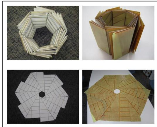
Abb. 25: Modell des Solarsegels im Maßstab 1:20 (Zirbel, Lang et al., 2013, S. 21)
