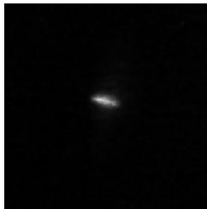
Abbildung 5.6: Eine vergrößerte Aufnahme der -3. Ordnung bei der Probe S1b bei  $\theta = 60^\circ$  und  $\varphi = 10^\circ$ . Die beleuchtete Fläche ist nicht kreisförmig, sondern ist in die Länge gezogen. Dies verfälscht die Koordinaten des Helligkeitsschwerpunktes.
