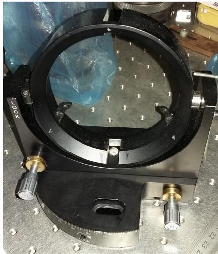
Abbildung 2.2: Die Probenhalterung wurde auf dem Rotationstisch befestigt. Die Probe wurde am inneren Ring befestigt, mit welchem der Winkel  $\theta$  eingestellt wurde. Mit Hilfe des Rotationstisches wurde der Winkel  $\varphi$  eingestellt.
