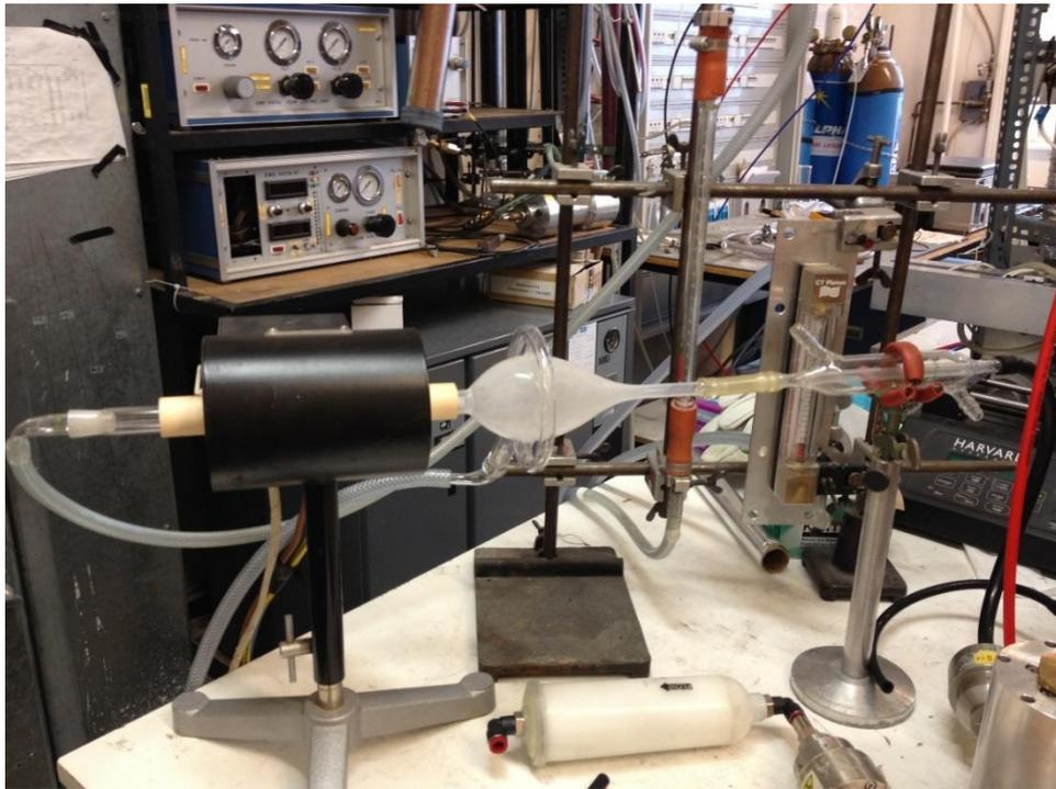
*Abbildung 3.9 Rohröfen zur Erzeugung von NaCl und Silber Partikeln*
