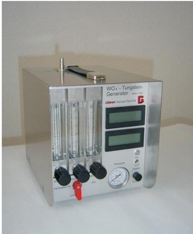
Abbildung 3.10 Tungsten-Oxid-Generator (Type Grimm 7.860).
