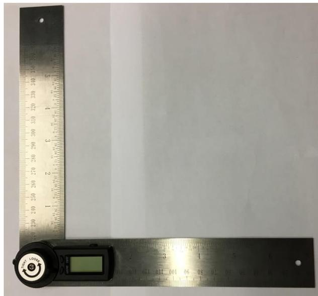
*Abb. 8: Digitaler Goniometer zur Feststellung der Kniewinkel
