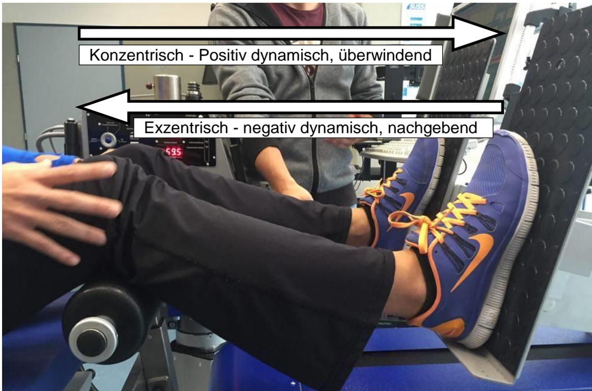
*Abb. 21: Prinzip des desmodromischen Krafttrainings: Gegen einen maschinell bewegten Widerstand (Kraftmessplatte) wird ständig Druck ausgeübt. Bewegungsarten: konzentrisch & exzentrisch (selbst erstellt)*
