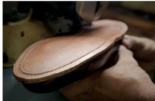
*Abbildung 7 In einem ersten Schritt wird der Rahmen (Lederstreifen) an die Brandsohle und das Oberleder genäht.
