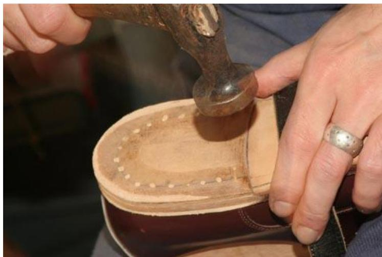
Abbildung 13 Absatzaufbau: Die Lederschichten werden übereinandergestapelt und mit Kleber und Nägeln befestigt.
