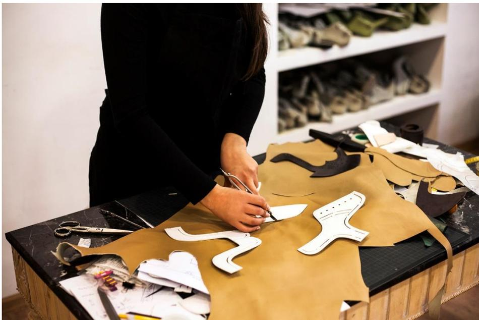
Abbildung 3 *Der Zuschneider legt die Modellschablonen auf das Leder und schneidet es mit einem speziellen Messer zu.*
