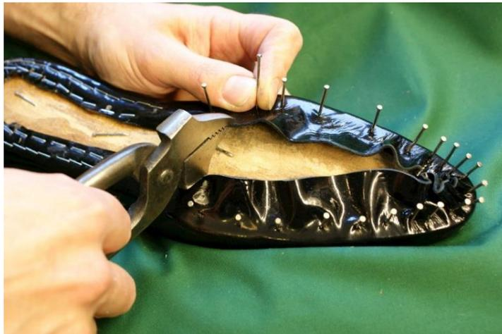
Abbildung 6 Mit einer Zange wird der Schaftteil über den Leisten gezogen und mit Nägeln fixiert.
