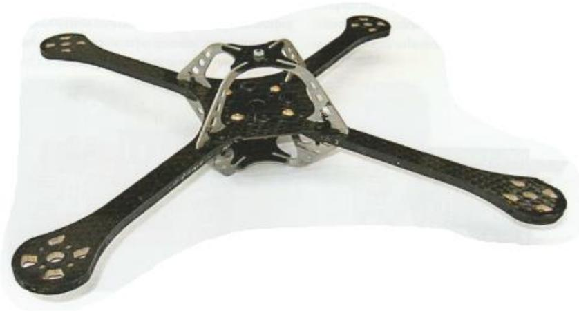
**Abbildung 24:** Ein crashsicherer Multikopter-Rahmen, der Elektronik und Batterie in einem Metallgehäuse schützt, Quelle: [BÜC-15: 32]
