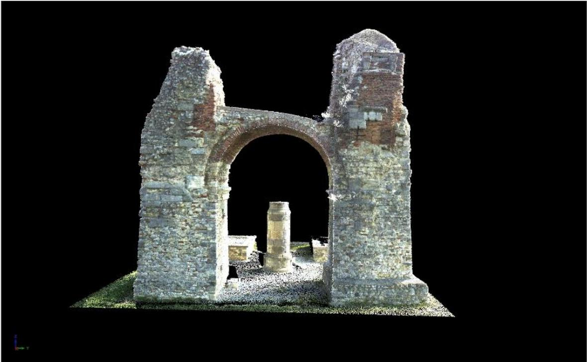
**Abbildung 62: Das fertige Modell des Heidentors, erstellt mit RiSCAN Pro**
