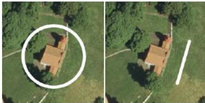
**Abbildung 39: In zwei Phasen durchgeführter UAV-Bildflug: Einmal kreisförmig um das gesamte Gebäude und einmal lineare Aufnahme der Frontfassade, Quelle: [PUE-08: 95]**
