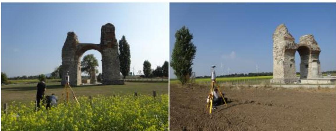
Abbildung 52: Aufnahmen mit dem VZ-6000 am Untersuchungsobjekt; Fotos: Tremel 2016
