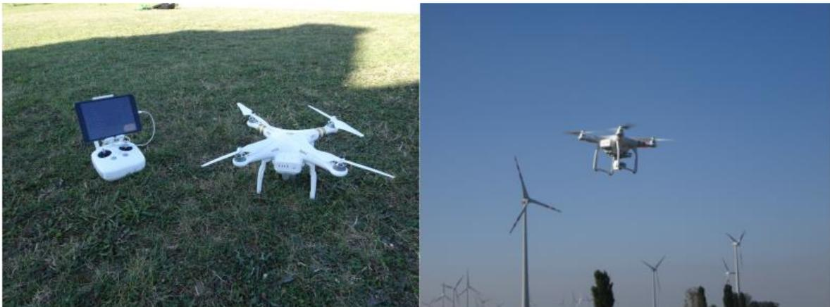
**Abbildung 63: DJI Phantom 3 Professional mit Fernsteuerung (links) und während des Bildflugs (rechts); Fotos: Tremel 2016**
