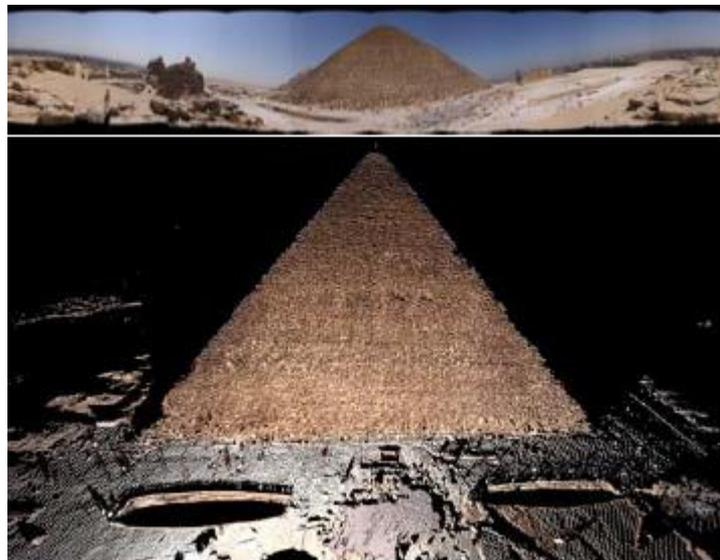
**Abbildung 35: Ein eingefärbter Scan der Cheops-Pyramide in RiSCAN Pro in einer 2D- (oben) und 3D-Ansicht (unten), Quelle: [NEU-05: 472]**
