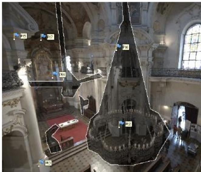
**Abbildung 46: Maskierung von unerwünschten Objekten im Mittelschiff der St. Nikolaus-Kirche, Quelle: [KOS-13: 137]**
