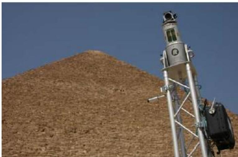
**Abbildung 34:** Der Riegl LMS Z420i mit kalibrierter Nikon D100 Digitalkamera und WLAN-Box vor der Cheops-Pyramide, Quelle: [NEU-05: 471]
