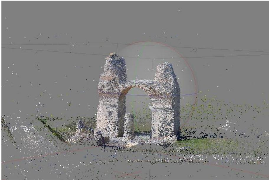
Abbildung 68: Ergebnis der Foto-Ausrichtung: Eine dünne Punktwolke des Heidentors
