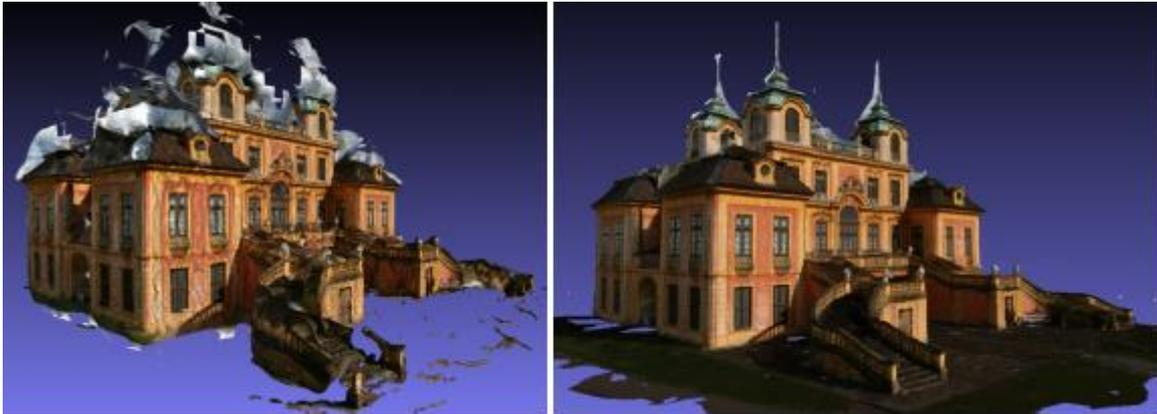
Abbildung 28: 3D-Modell mit CMVS/PMVS2 (links) und CPMVS (rechts), Quelle: [ZIE-14: 5]
