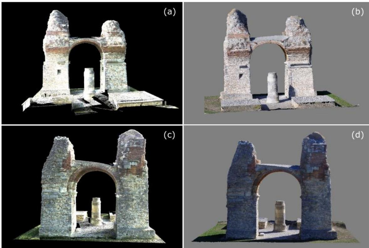
Abbildung 76: Ergebnis der Datenauswertung: (a) und (c) zeigen Vorder- und Rückseite des Heidentors als texturierte Punktwolke in RiSCAN; (b) und (d) zeigen das fertige Modell in Agisoft PhotoScan
