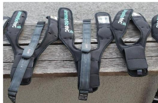
**Abbildung 26: LPM-Weste mit Transponder und Herzfrequenzmessgeräte (Polar)**
