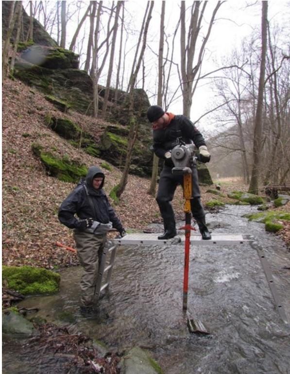
ABBILDUNG 34: I: EINSCHLAGEN DES CORES
