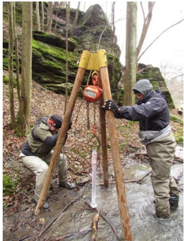
ABBILDUNG 37: IV: ENTNAHME DES CORES
