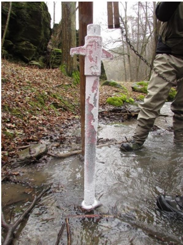
ABBILDUNG 36: III: DURCHGEFRORENER CORE
