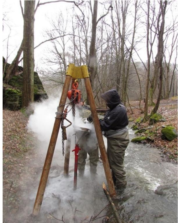
ABBILDUNG 35: II: BEFÜLLEN DES CORES MIT STICKSTOFF
