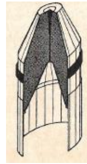
Abbildung 250: 7-kg-Hohlladung; aus AVPi 65 „SPRENGEN“, Seite 18
