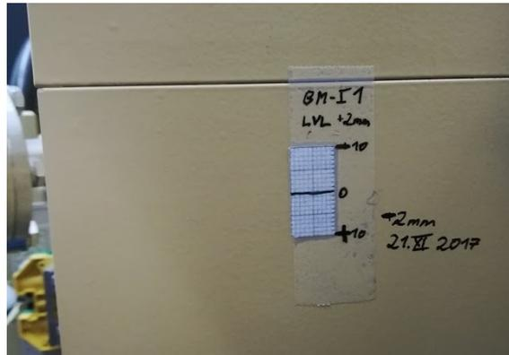
Abbildung 3.1.: Höhenmessmarkierung am Ablenkmagnet BMI1 mit nebenstehender Höhenabweichung des Magneten, mit Datum versehen.
