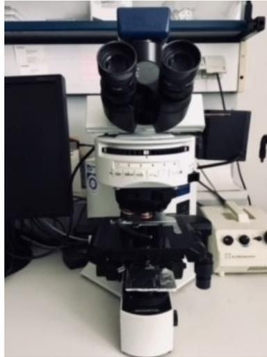
**Abbildung 12:** Fluoreszenzmikroskop Olympus BX51 mit aufgesteckter Progres Gryphax® Kamera
