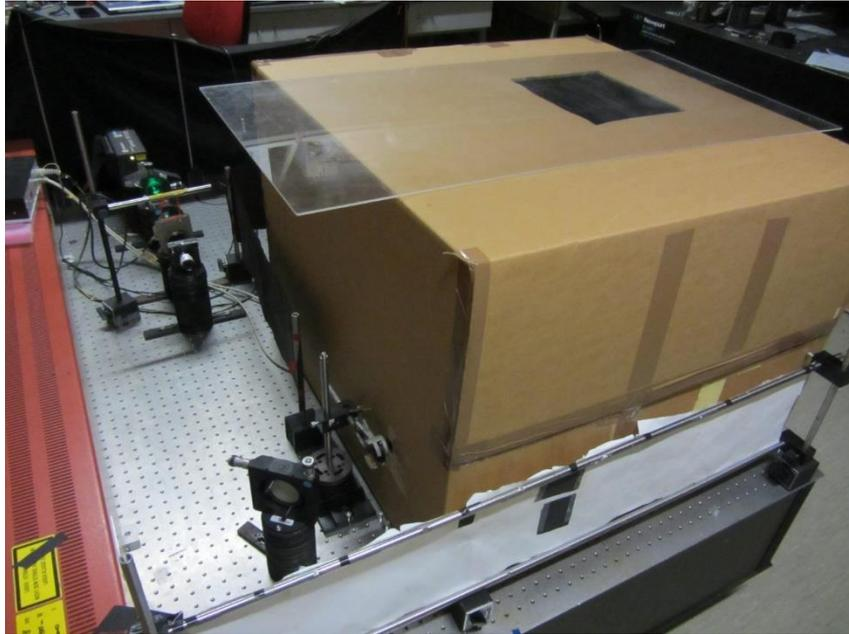
Abbildung 2.11: Eine für den Zweck, optische Aufbauten von Luftbewegungen abzuschirmen, optimierte Struktur aus einem mehrlagigen Material auf Zellulosebasis – Kartonage – wurde in den bestehenden Aufbau integriert und mit einer Plexiglasplatte abgedeckt, um die Deckenöffnung, die Zugriff zum Interferometer und den Dioden gewährt, zu schließen.
