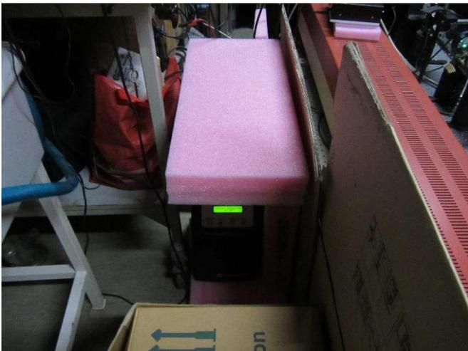
Abbildung 3.9: Um den Einfluss des Lüfters zu minimieren, wurde er mit Polyethylenplatten eingedeckt.
