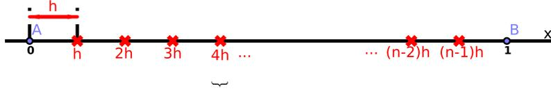
Abbildung 7: Diskretisierung des Modells des zylinderförmigen Körpers
