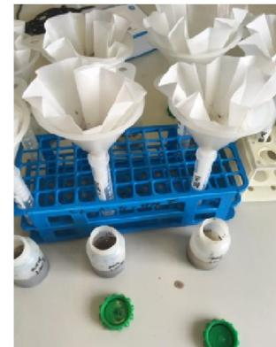
*Abbildung 34 Filtrieren der Proben
