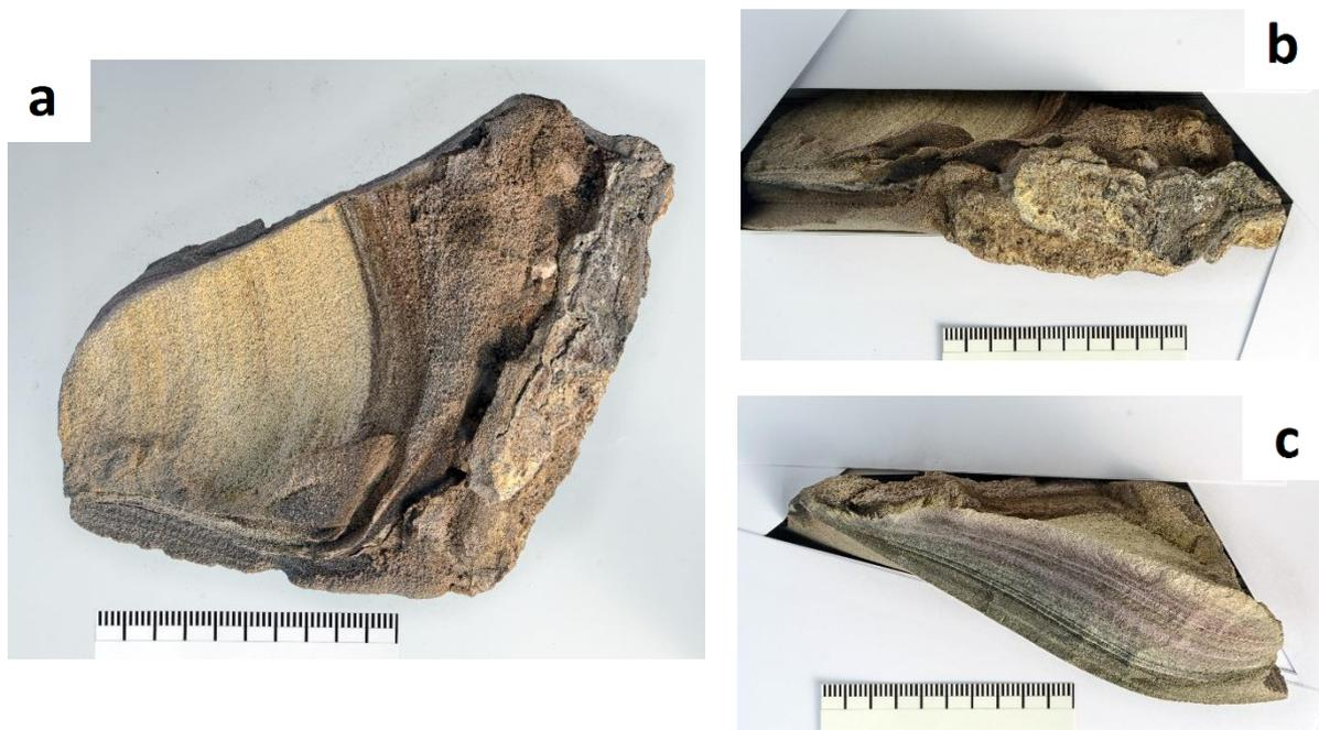
Abbildung 20: Handstück der Probe 6. Dabei handelt es sich um eine Probe aus der Brennkammer des Kessels. (a) Ansicht von oben (b) Spuren der Oberflächenschichte an der Seitenfläche (c) Seitenansicht, in welcher die unterschiedlichen Lagen des Handstücks zu sehen sind.
