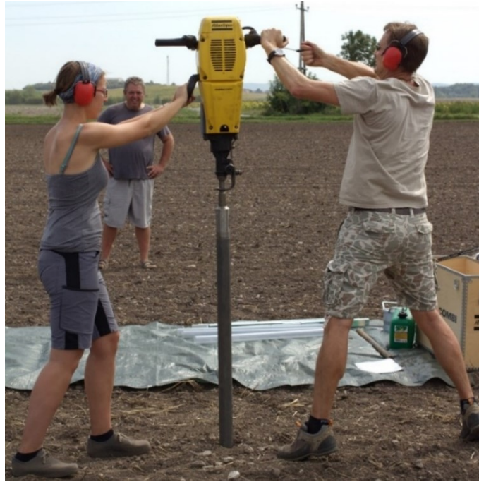
Abb. 31: Start des motorisierten Bohrhammers mit unten angeschraubtem Bohrkopf; Bohrung im Bereich des äußeren Grabens (2017/1-3) (Foto: Felix Köstelbauer).
