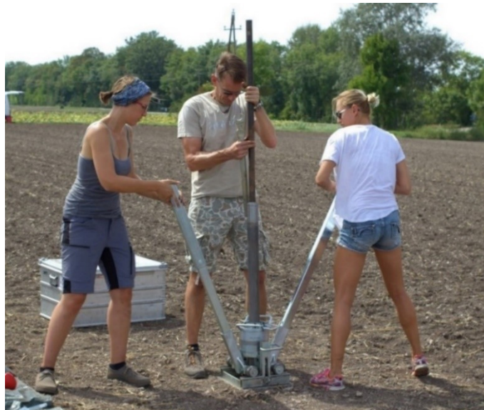
Abb. 32: Bergung des Bohrkerns mit Hilfe des Ziehgeräts; Bohrung im Bereich des äußeren Grabens (2017/1-3) (Foto: Felix Köstelbauer).
