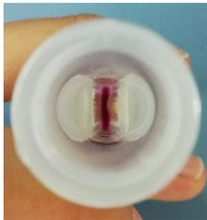
*Abbildung 32 – Retentat im 50 000 MWCO Filter nach Filtration von Überstand aus Kultivierung PIP\_506 – Eine deutliche Färbung, korrespondierend zum Fluoreszenzmarker, ist zu erkennen.*
