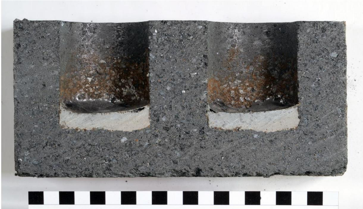
Abbildung 50: Probe V4 ist ein Low Quality Magnesia-Carbonstein Typ 0180 mit den Maßen 21x4,7x9cm, befüllt mit der mittleren Schlackenzusammensetzung.
