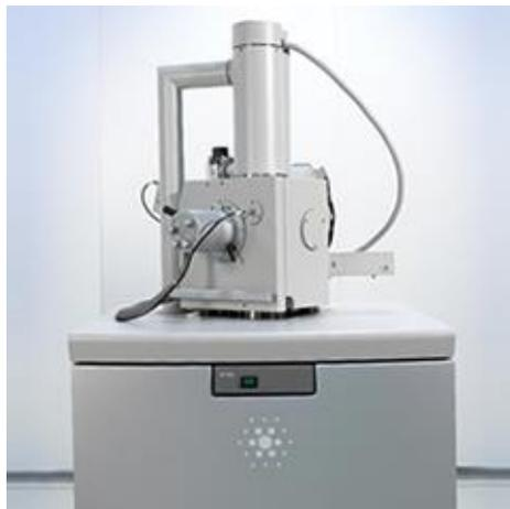
Abbildung 2: Das im Rahmen dieser Masterarbeit verwendete Modell: FEI Inspect S-50 (<http://www.fei.co.jp/HTMLPage.htm>)
