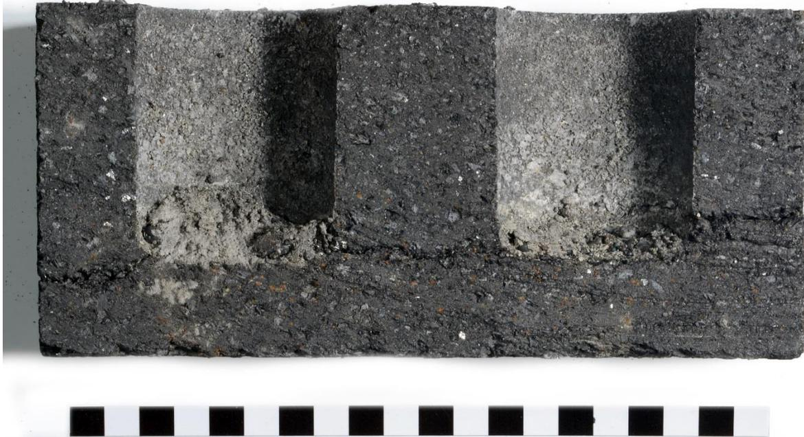
Abbildung 4: Probe V1 ist ein High Quality Magnesia-Carbonstein Typ 1298 mit den Maßen 21x4,3x10cm, befüllt mit der finalen Schlackenzusammensetzung.
