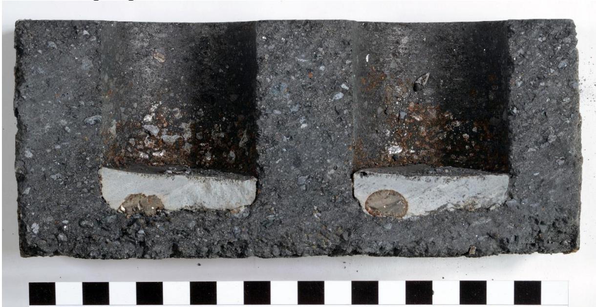
Abbildung 66: Probe V5 ist ein High Quality Magnesia-Carbonstein Typ 1298 mit den Maßen 21x4,3x10cm, befüllt mit der mittleren Schlackenzusammensetzung.
