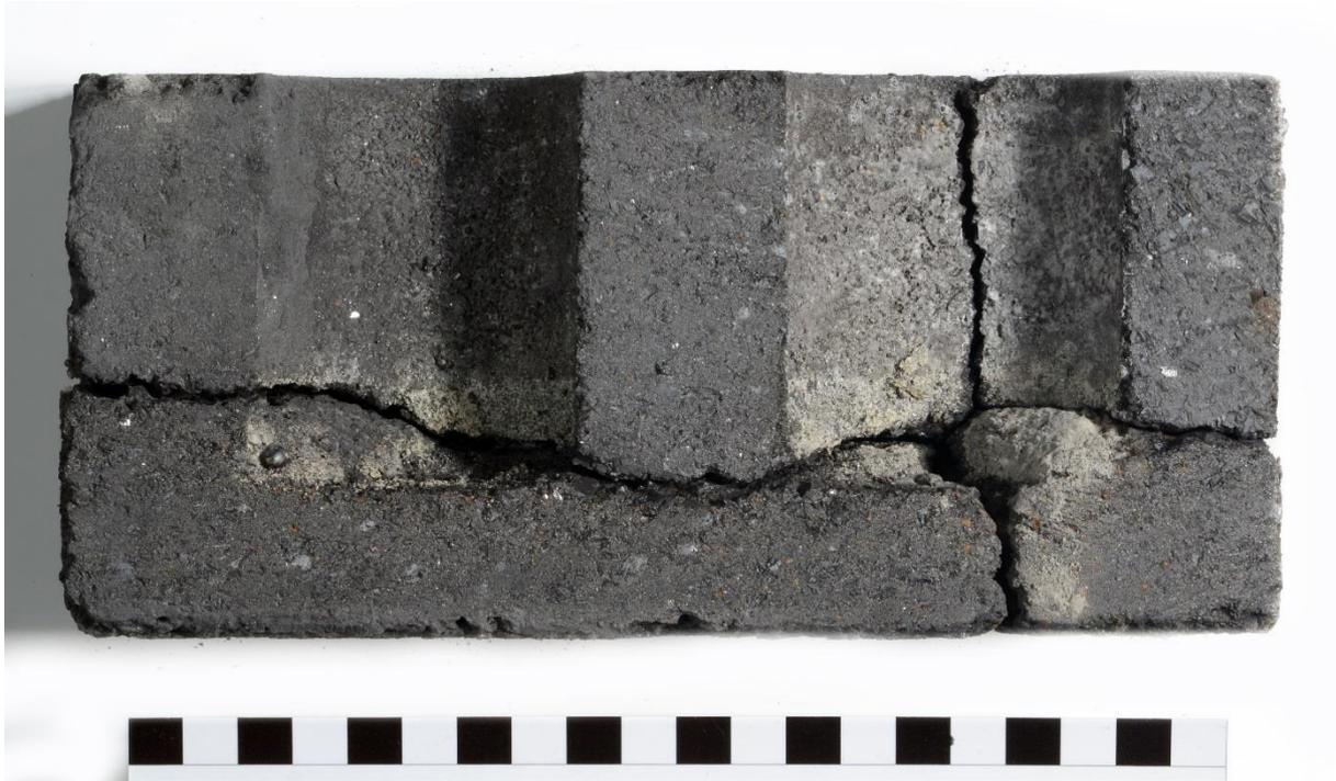
Abbildung 20: Probe V2 ist ein High Quality Magnesia-Carbonstein Typ 1298 mit den Maßen 21x4,3x10cm, befüllt mit der finalen Schlackenzusammensetzung.
