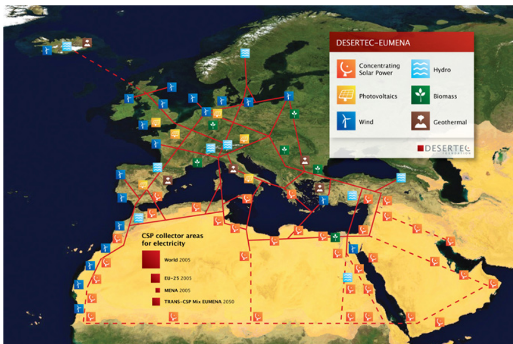
Fig. L.1. Schematische Darstellung des Projekt Desertec . Im Zuge dieses Projekts sollten Photovoltaikanlagen in der Wüste, Windräder an der Küste und ein neues Netz für den Stromtransport nach Europa gebaut werden. Die zwei großen roten Quadrate geben dabei die errechnete Größe von möglichen Photovoltaikanlagen an, die die ganze EU bzw. sogar die ganze Welt mit Strom versorgen könnten. ©Desertec ( https://www.dlr.de/next/desktopdefault.aspx/tabid-6782/11133_read-25363/ , letzter Zugriff: 31.05.2020).
