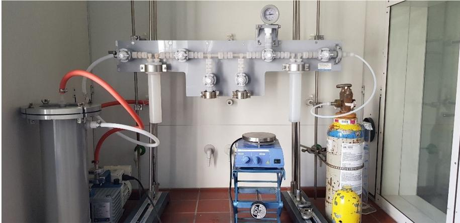
**Abbildung 7a** Am Foto ist die verwendete HF-Anlage abgebildet, welche zur Boc-Einschützung und Abspaltung der Peptide von der stationären Phase verwendet wurden.
