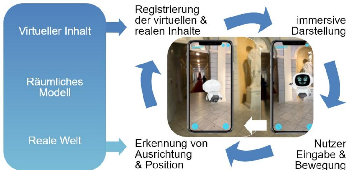
Abbildung 8: Kreislauf eines AR-Systems. Wechselwirkung zwischen Benutzer und Computersystem. Quelle: Eigene Darstellung nach einer Grafik von Schmalstieg und Höllerer (2016, S. 37)
