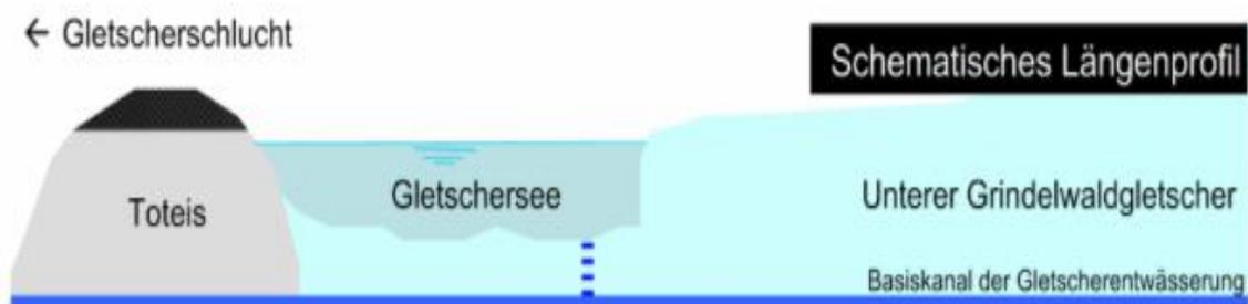
Abbildung 37: Schematisches Längsprofil des Unteren Grindelwaldgletschers und graphische Darstellung der natürlichen Entwässerung des Gletschersees; Quelle: Oberingenieurkreis I
