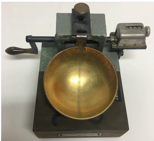
Abbildung 14: Links, Klopfschale. Rechts, Probe KB_TS vor dem Trocknen
