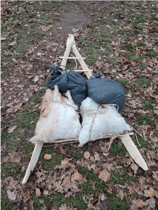
Schleifen (Abb. 7) nutzen das Kufenprinzip und werden mit Gurten beispielsweise an einem Joch befestigt. Diese Zugvorrichtung weist aufgrund der geringen Bodenkontaktfläche einen geringen Reibungswiderstand auf und die Unterkonstruktion hat ein relativ geringes Eigengewicht. Optimale Wirkung entfaltet diese Transportweise bei kopfgroßen Unebenheiten und talwärtiger Lastenbeförderung. Für Menschen war diese Transportmöglichkeit auf langen Transportstrecken eher weniger geeignet.<sup>203</sup>
