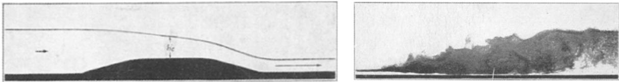
Abbildung 61: links: Fließende Strömung wird zu schießender Strömung; rechts: schießende Strömung wird zu fließender Strömung; Abbildungen aus Schweitzer, 1952
