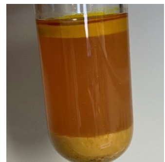
Abbildung 2: Rohsaft nach 15-minütiger Zentrifugation (30.000 U/min) zeigt deutliche Phasentrennung
