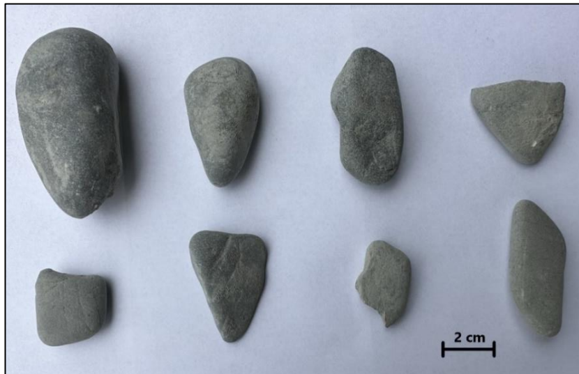
Abbildung 25: Komponenten der Kiesfraktion von Probe 171-14,7m zur Bestimmung der Kornform
