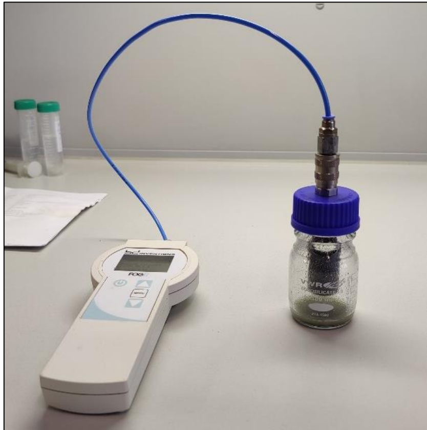
Abbildung 18: Messung des Karbonatgehalts mittels Kalkimeter
