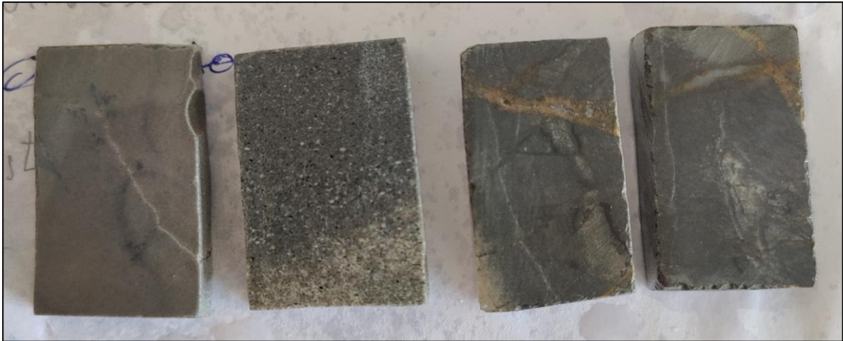
Abbildung 19: Kieskomponenten nach dem Zuschneiden mit der Gesteinssäge
