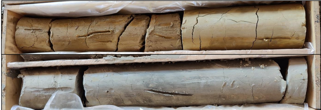
Abbildung 3: Farbunterschied zwischen braunem, verwittertem Tegel (oben) und blaugrauem, nicht verwittertem Tegel (unten) aus dem Sarmatium (RKB 221)
