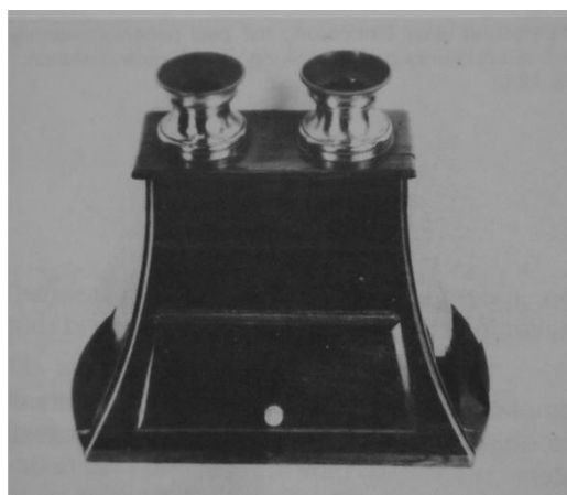
Abb. 6: Brewster-Stereoskop mit Röhren.
