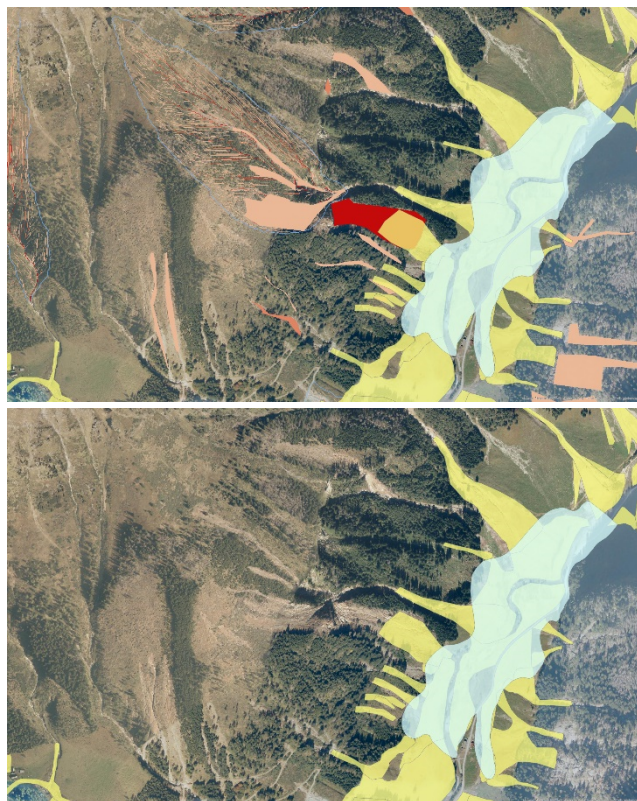
Abbildung 38: Ausschnitt aus dem Orthofoto von 2010 nach dem Extremereignis mit Anrissen von Hangmuren und einer kleineren Gerinnemure (Oben) und ohne die digitalisierten Anrisse (Unten). Auf beiden Ausschnitten sieht man die Stauung beim Stiegelbach (türkis) und die digitalisierten Schadensflächen (gelb) (Quelle: eigene Darstellung; Datengrundlage: LAND STEIERMARK 2023).
