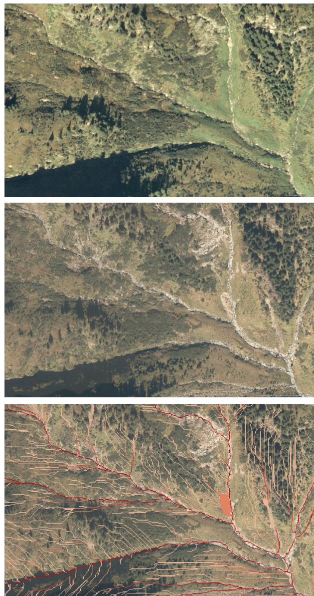
Abbildung 37: Ausschnitte von Orthofotos von 2006 (Oben) und nach dem Extremereignis 2010 (Mitte) sowie mit den flächigen und linienhaften Anrissbereichen (Unten), wobei je roter die Farbe, desto mächtiger die Anrisstiefe (Quelle: eigene Darstellung; Datengrundlage: LAND STEIERMARK 2023).
