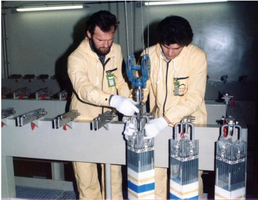
Abbildung 14: Manipulation von Brennelementen im Brennelementtrockenlager (EVN Archiv, Maria Enzersdorf).
