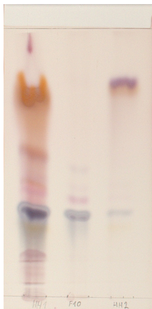
Abbildung 12: Analytische DC: Kontrolle der aufgereinigten Banden HH1 (links), HH2 (rechts) und F10 als Referenz (Mitte) Mobile Phase: \text{CHCl}_3 + \text{MeOH} (99+1) Derivatisierungsreagenz: Anisaldehyd/Schwefelsäurereagenz: Weißes Licht
