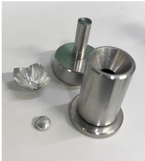
Abbildung 16: Gepresste Probe in Zinnfolie mit Hilfe der Presse (Eigene Darstellung)
