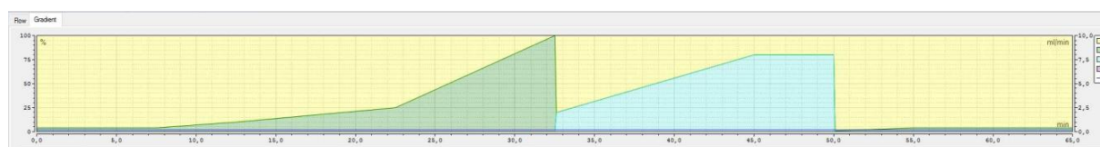
Abbildung 17: Gradientenprofil der HPAEC-PAD zur Bestimmung der Mono-, Di- und Oligosaccharide.
