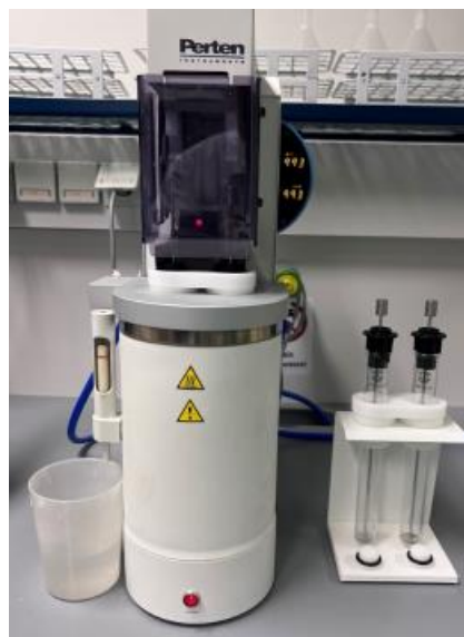
Abbildung 18: Fallzahlgerät (links) und Viskosimeterrohr mit Rührviskosimeter (rechts). Eigene Darstellung.
