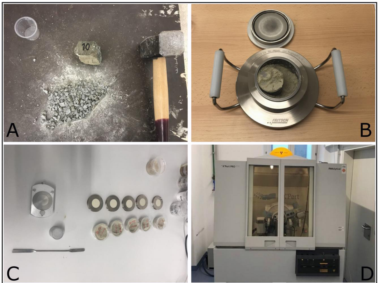
Abbildung 2-3: Vorbereitung der Proben für die Pulverdiffraktometrie zur Mineralanalyse A) Zerkleinern der Proben mit einem Hammer zur Vorbereitung auf das Mahlen. B) Mahlen des zerkleinerten Materials in der Scheibenschwingmühle, um eine gleichmäßige Feinheit zu gewährleisten. C) Vorbereitung und Verpackung der Proben im Backloading-Verfahren, um eine texturfreie Probe für die Analyse zu erhalten. D) Durchführung der Analyse mit einem PANalytical X'Pert Pro MPD Diffraktometer zur Bestimmung des Mineralbestands der Proben.
