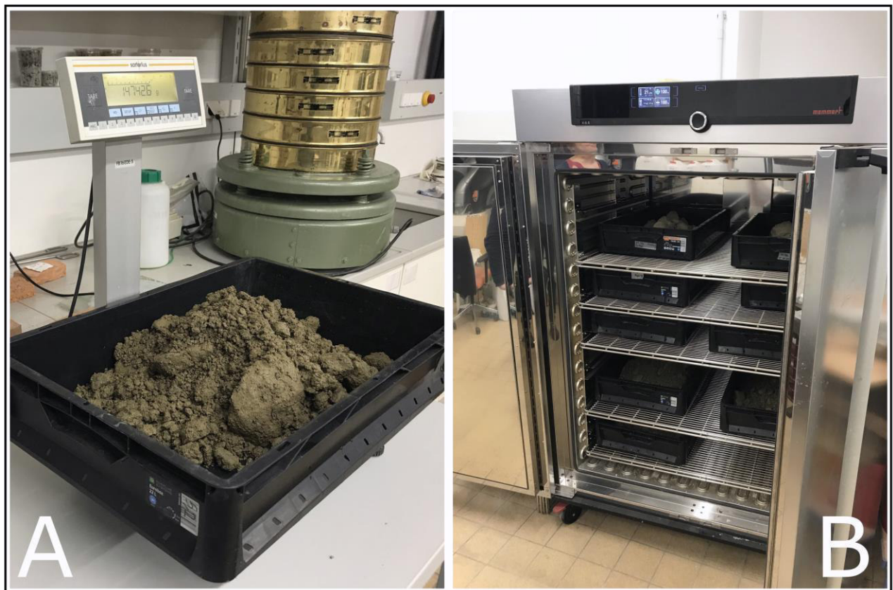
Abbildung 2-2: Vorbereitung der Proben für die Korngrößenanalyse. A) Die Proben wurden zur Bestimmung von Gewicht und Wassergehalt gewogen, wobei das Gewicht regelmäßig bis zur Erreichung der Gewichtskonstanz kontrolliert wurde. B) Die Proben befinden sich im Trockenschrank; dieser Schritt dient dazu, sicherzustellen, dass kleinere Partikel nicht an größeren haften bleiben und die Siebe während des Siebvorgangs nicht verstopfen.
