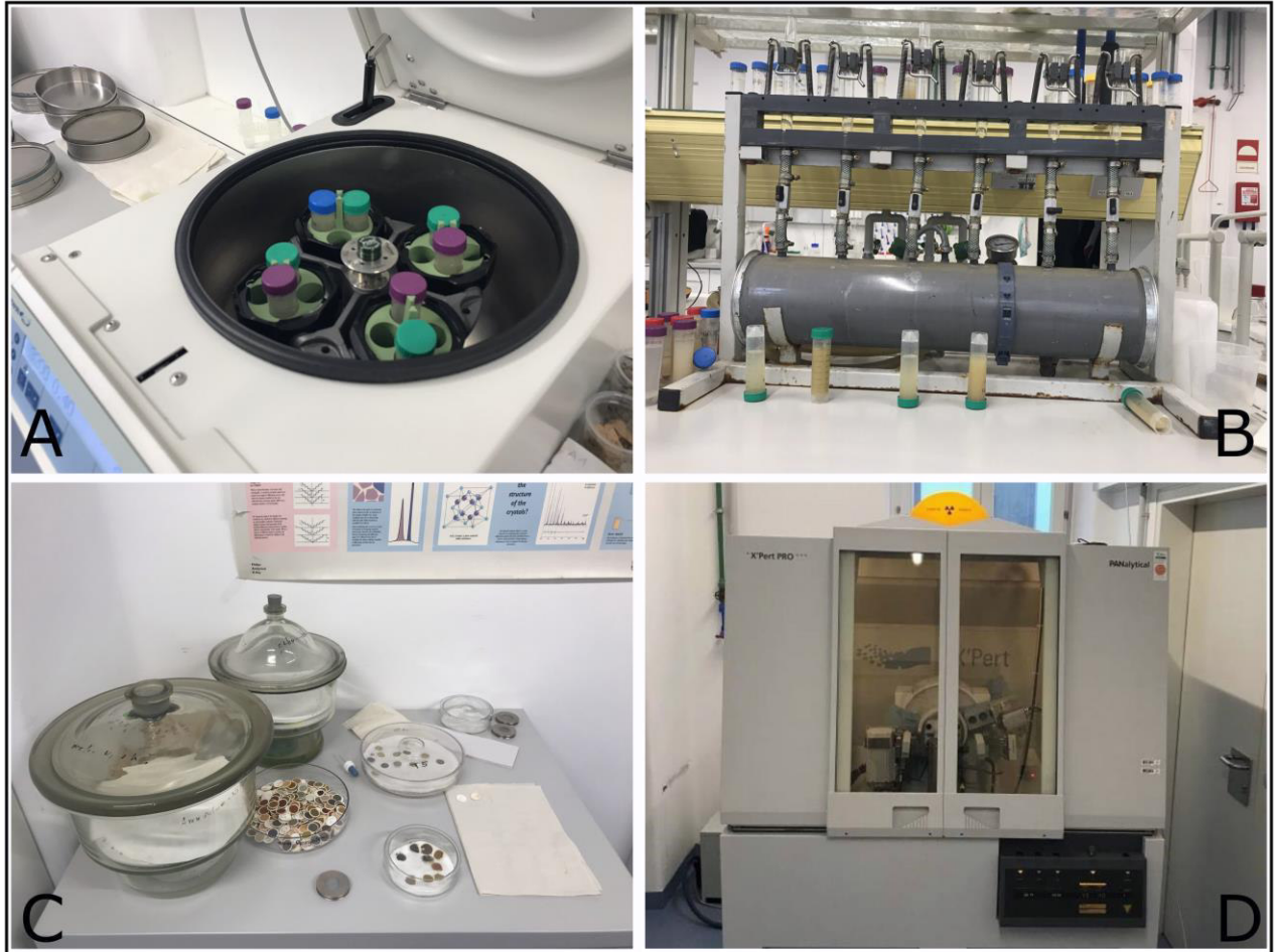
Abbildung 2-4: Probenaufbereitung für die Tonmineralanalyse. A) Zentrifugation zur Abtrennung der Tonfraktion. B) Präparation von porösen Keramikplättchen für die Sorptionsanalyse. C) Exsikkation der Proben und Vorbereitung der Texturpräparate. D) Röntgendiffraktometer PANalytical X'Pert Pro zur Analyse der mineralogischen Zusammensetzung.
