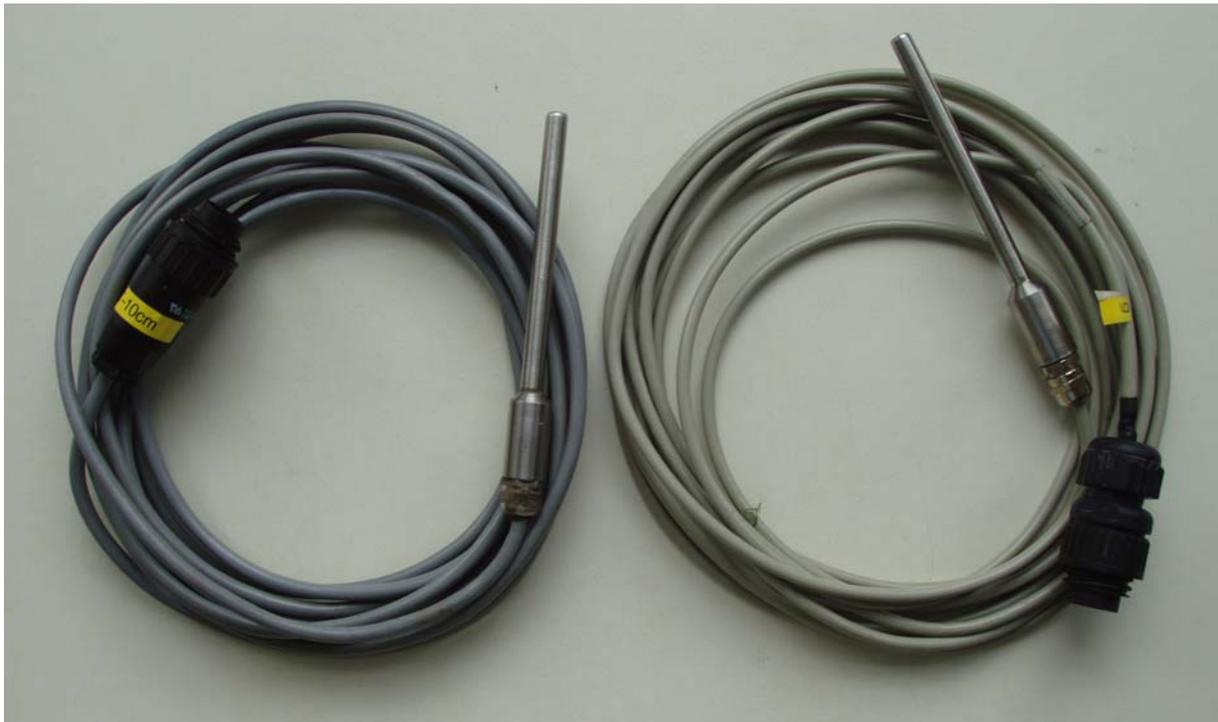
Abbildung 3: Platinwiderstandsthermometer
