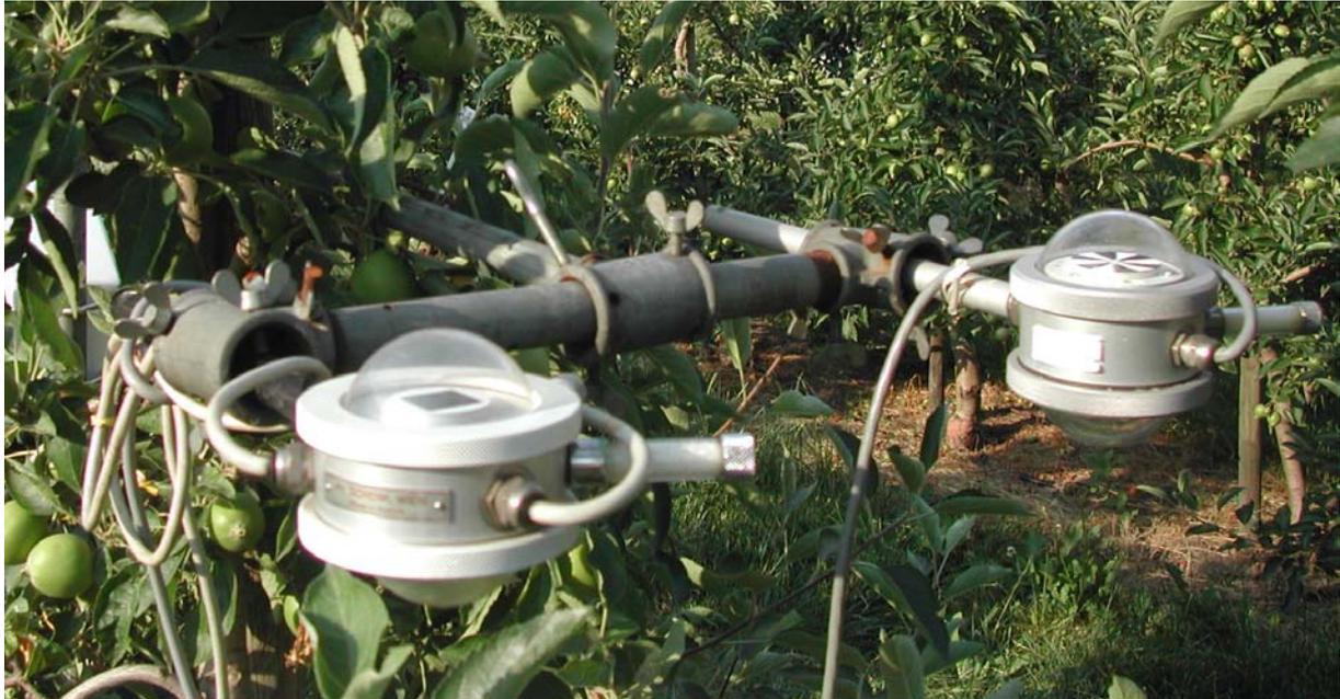
Abbildung 2: Strahlungsbilanzmesser (links) und Doppelpyranometer (rechts)
