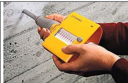
Abbildung 5-5: Diese Abbildung zeigt den Einsatz des „Schmidt - Hammers vom Typ NR“ zur Werkstoffprüfung. ([www.proceq.com](http://www.proceq.com))
