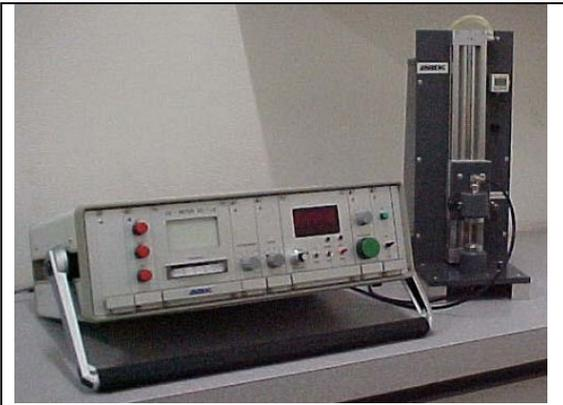
Abbildung 5-10: Diese Abbildung zeigt das für die Ultraschallmessungen verwendete Gerät der Firma Labek (aus Fleischer 2002).
