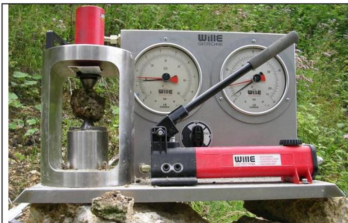
**Abbildung 5-7:** Diese Abbildung zeigt den Einsatz des Punktlastgerätes im Feld (im Bild ein Gerät der Firma Wille Geotechnik, Institut für Ingenieurgeologie an der TU Wien).
